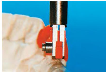
Mit dem Parallelhalter kann der Riegel perfekt platziert werden. Am Parallelhalter ist ein Blindmechanismus, somit ist die perfekte Platzierung möglich.
